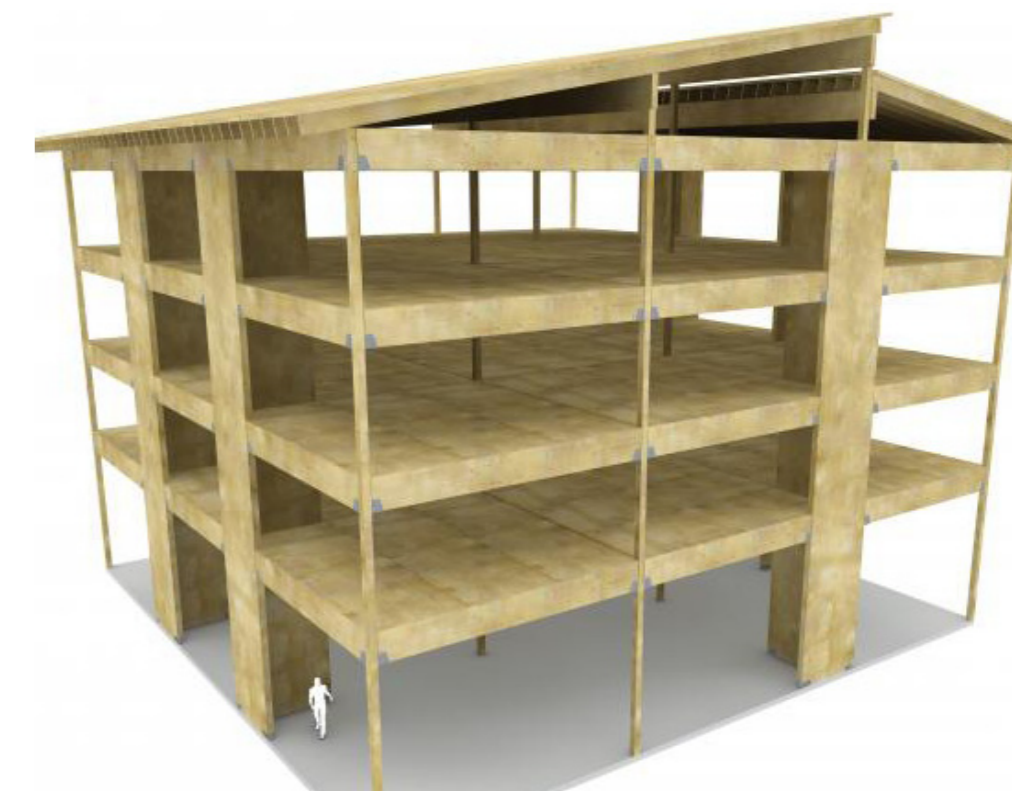
Kuva 27: Suurimmat kasvumahdollisuudet puurakentamisessa ovat suurimittakaavaisessa rakentamisessa. Kuvassa Finnforeestin Kerto-Ripa elementit.
