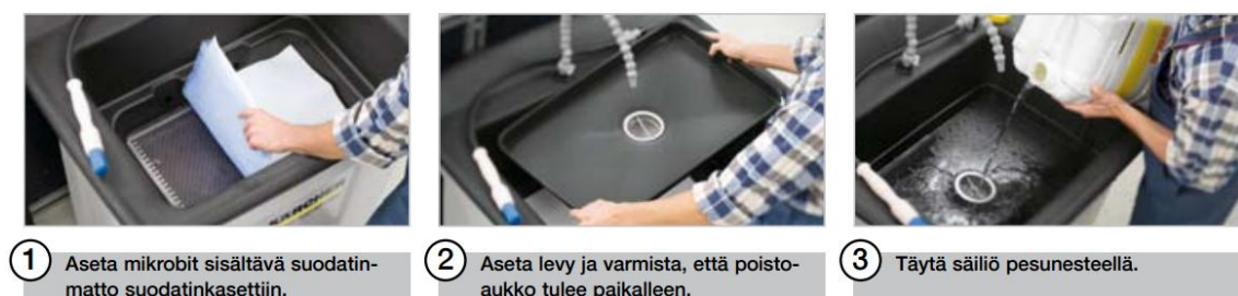
Kuva 6. Suodatinmaton vaihtaminen ja nesteen lisäys.
