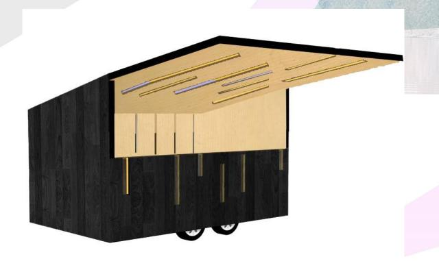
THE FRONT WALL WORKS ALSO AS A SHELTER WHEN YOU FLIP IT UP! GAS SPRING
