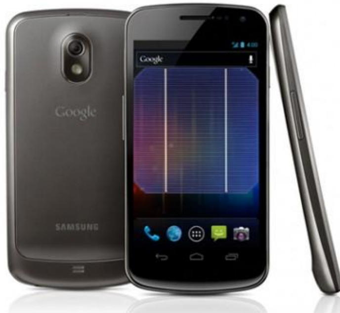
Kuva 10. Älypuhelin jonka näytön takana on aurinkopaneelit [22].
