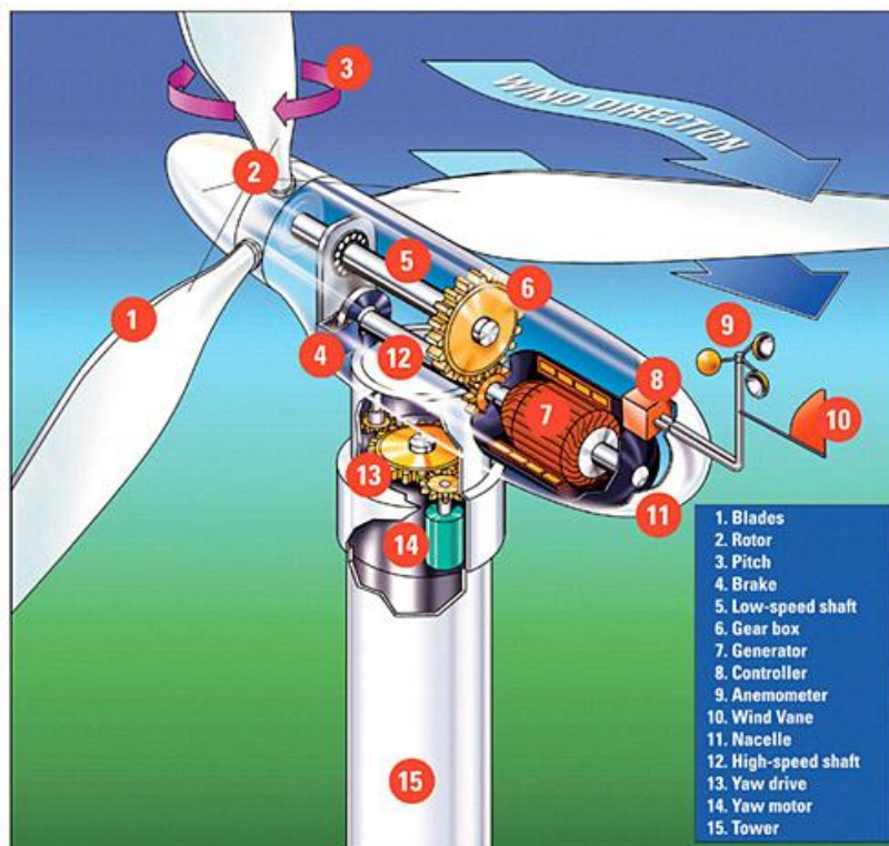
Kuva 17. Tuuliturbiinin sisäinen rakenne [31].
