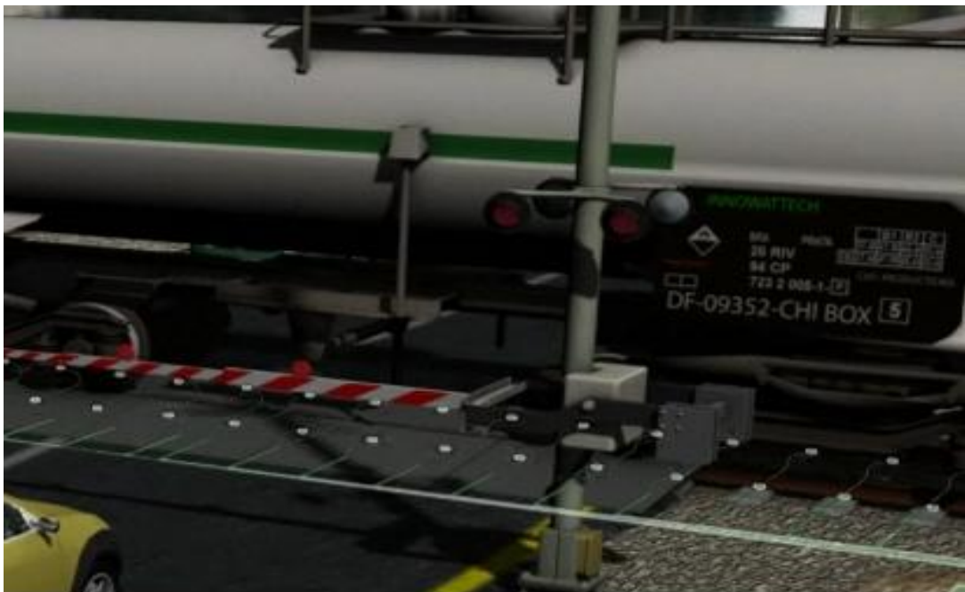
Kuva 13. Kiskoihin asennetut pietsoelementit tuottavat sähköä [24].
