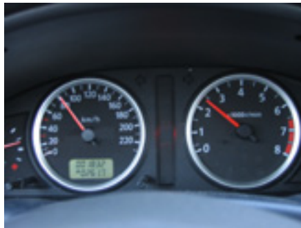
Kierroslukumittari, joka kertoo moottorin todellisen kierrosnopeuden. Taloudellisin kierrosalue henkilöautoissa on 2000 - 3000 rpm alueella.
