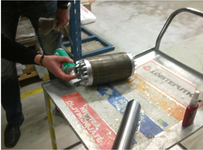
Kuva 5. Roottoripakan sisus puhdistetaan Loctite 7063 -puhdistusaineella.
