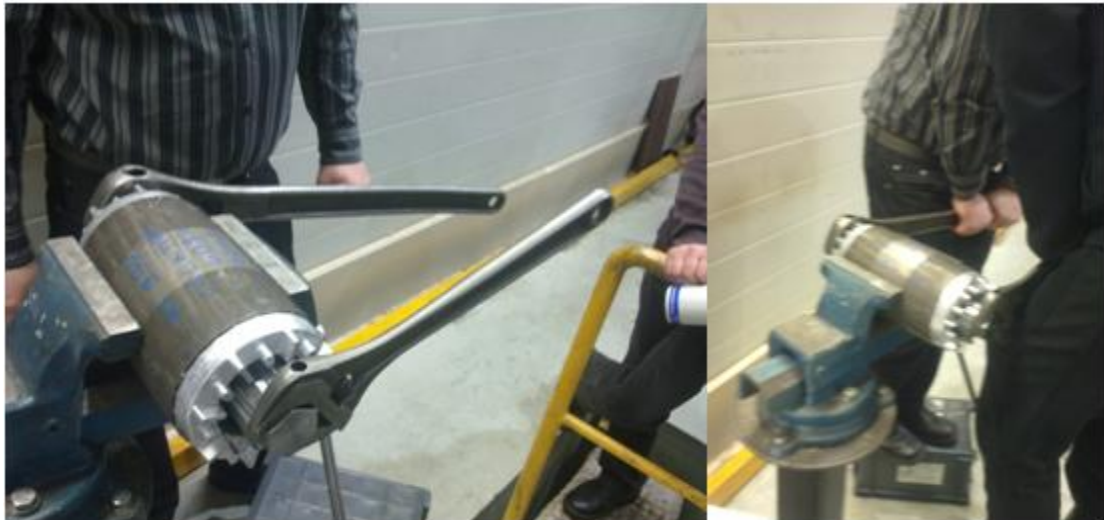
Kuva 9. Liitoksen lujuuden testaaminen vaihe 1.
