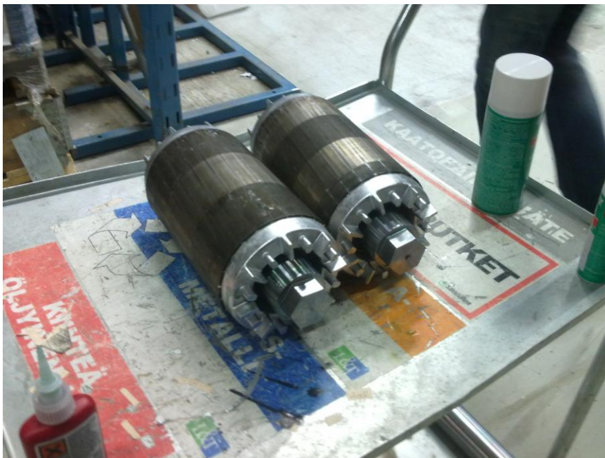
Kuva 8. Akselit ovat liimattuina roottoripaketeissaan.
