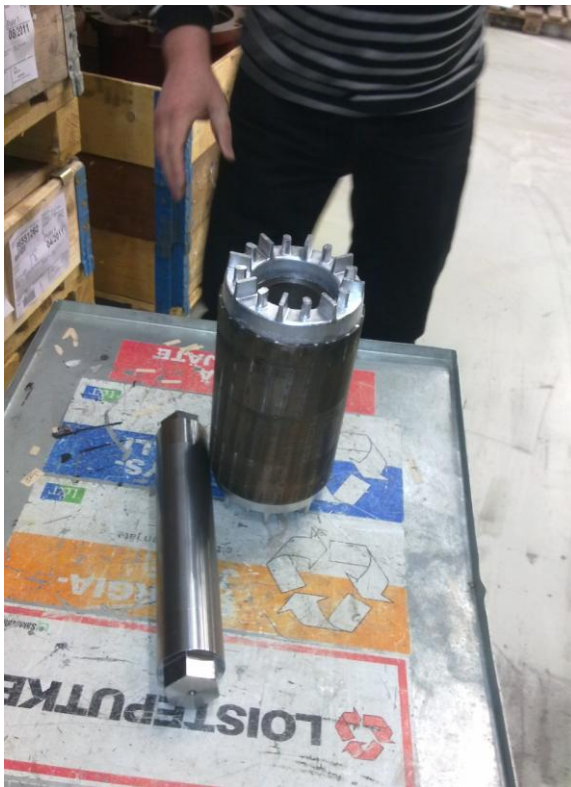
Kuva 4. Akseli ja roottoripakka valmiina liimaustestiin.
