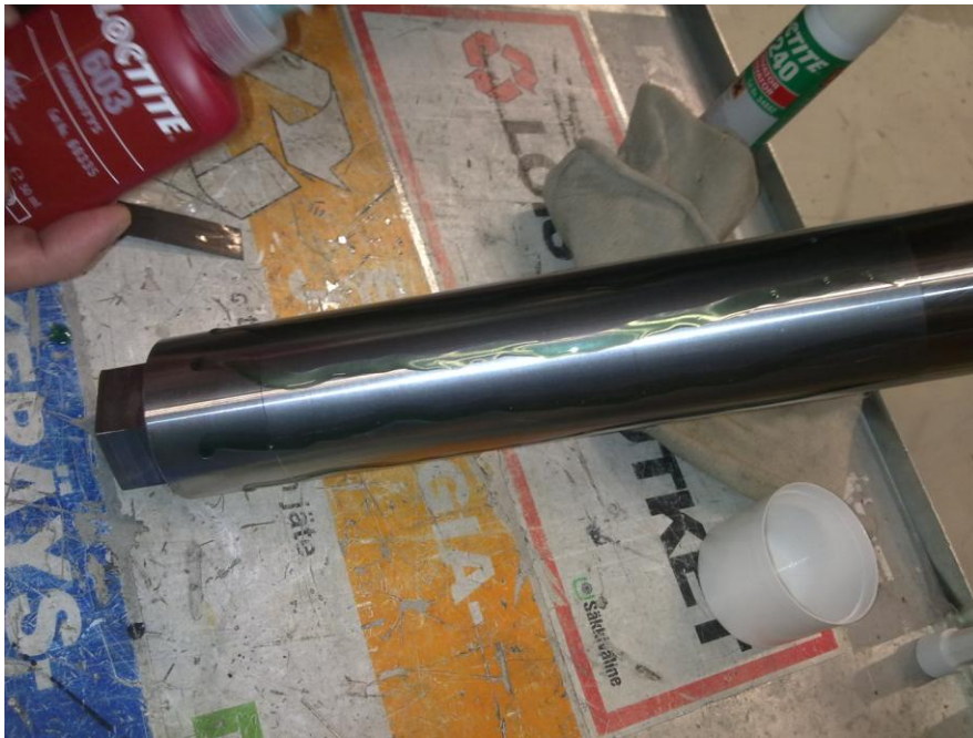
Kuva 7. Akseli numero 2, jossa on liimaa ja Loctite 7240 -aktivaattoria.
