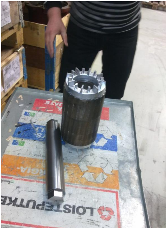
Kuva 4. Akseli ja roottoripakka valmiina liimaustestiin.
