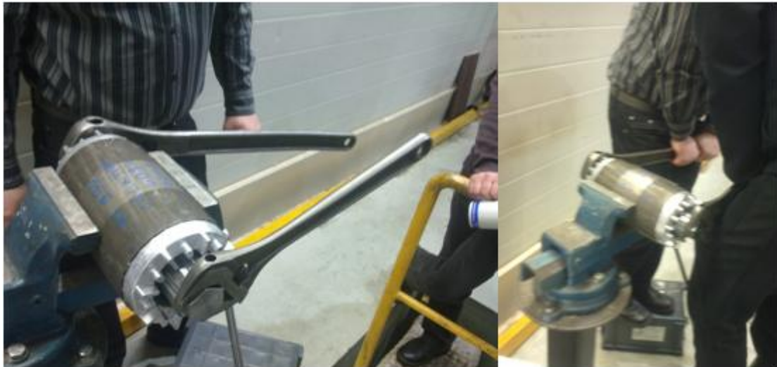
Kuva 9. Liitoksen lujuuden testaaminen vaihe 1.
