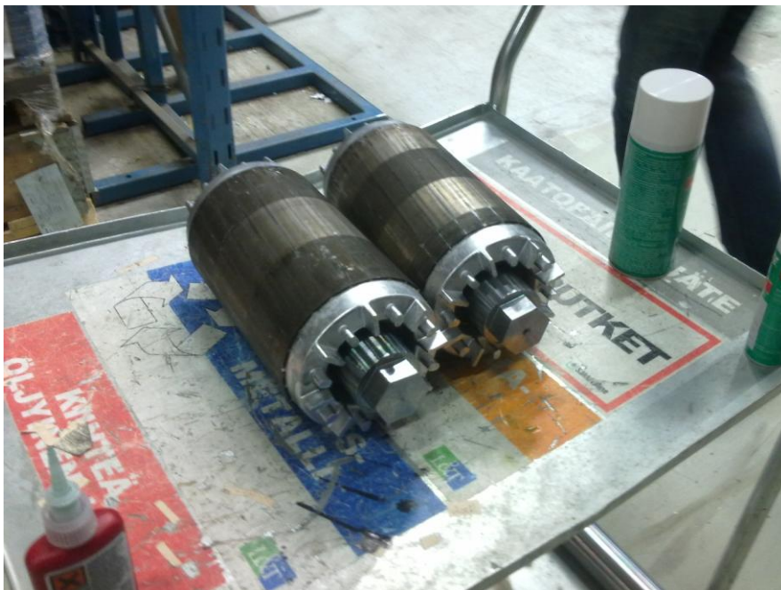
Kuva 8. Akselit ovat liimattuina roottoripaketeissaan.
