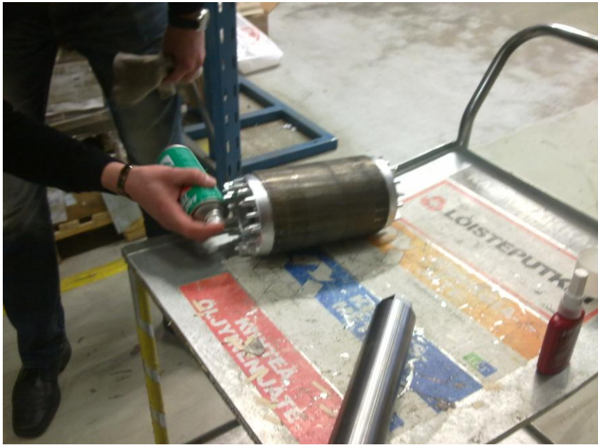
Kuva 5. Roottoripakan sisus puhdistetaan Loctite 7063 -puhdistusaineella.
