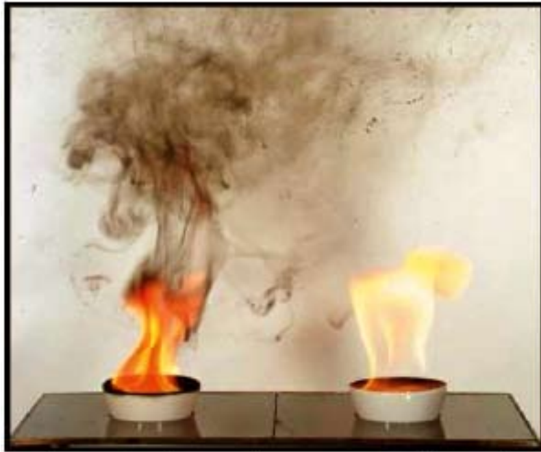
Kuva 7. Tavanomaisen (vasemmalla) ja synteettisen dieselpolttoaineen (oikealla) palaminen avonaisessa astiassa. Kuva ASFE (2006), Nylund & Aakko-Saksa (2007).
