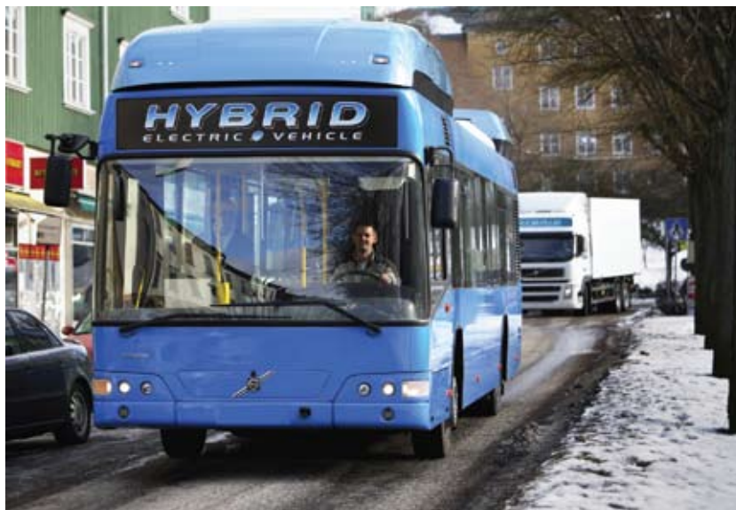
Kuva 13. Volvon hybridibussit käyttävät sekä mekaanista että sähköistä voimansiirtoa. Kuva Volvo.
