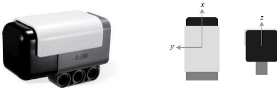
Kuvio 3. HiTechnic NXT Acceleration/Tilt Sensor ja mittausakselien asettelu.
