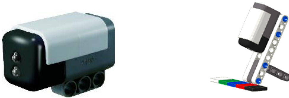
Kuvio 5. HiTechnic Color Sensor (V2) ja sen käyttöesimerkki.
