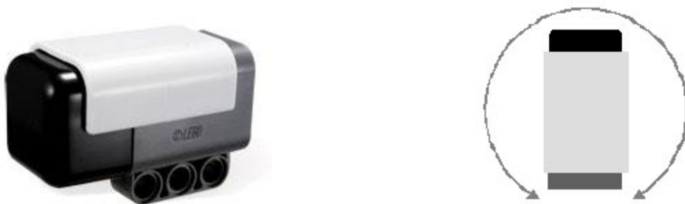
Kuvio 6. HiTechnic Gyro Sensor ja sen mittaus alue.
