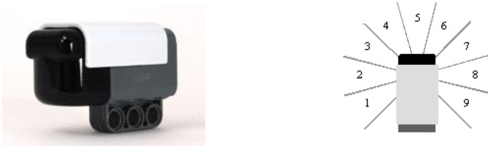
Kuvio 9. HiTechnic IRSeeker V2 anturi ja havaintoalueet.
