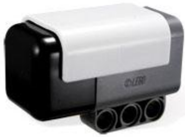
Kuvio 5. HiTechnic Gyro Sensor ja sen mittaus alue.
