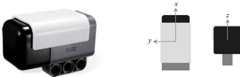
Kuvio 2. HiTechnic NXT Acceleration/Tilt Sensor ja mittausakselien asettelu.
