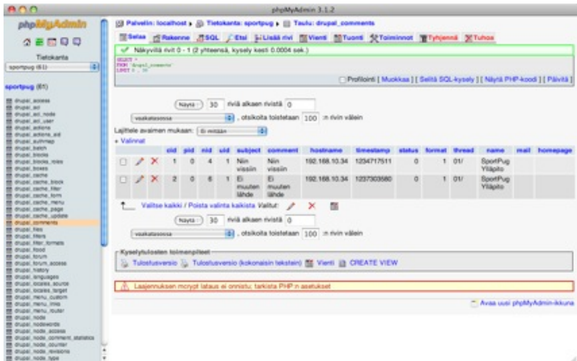
Kuva 5: Drupal -järjestelmän tietokannan tauluja phpMyAdmin -ylläpitotyökalun näkymässä.
